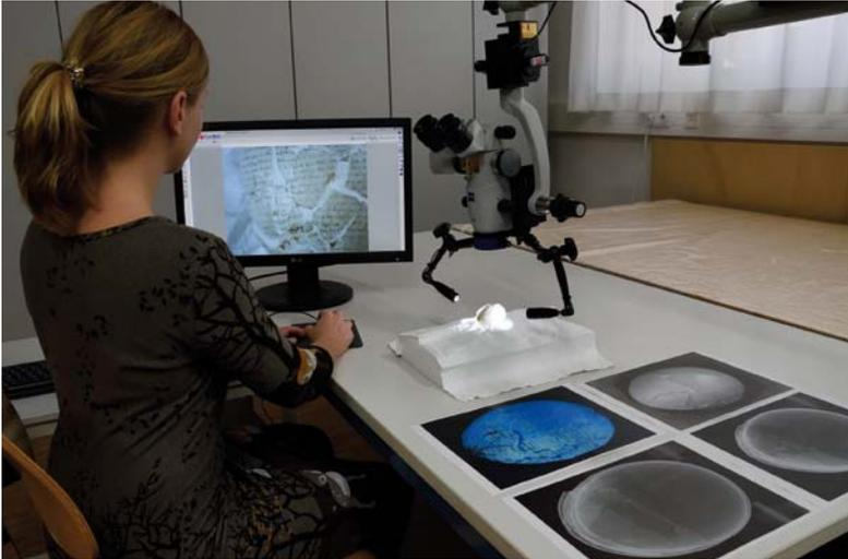
Untersuchungssituation: Abgleich der Aufnahmen UV, IR und X-Ray mit dem Original.
