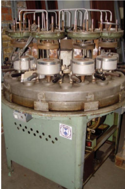
Einschmelzmaschine für Oszillographenröhren, Unikat, 1960.
