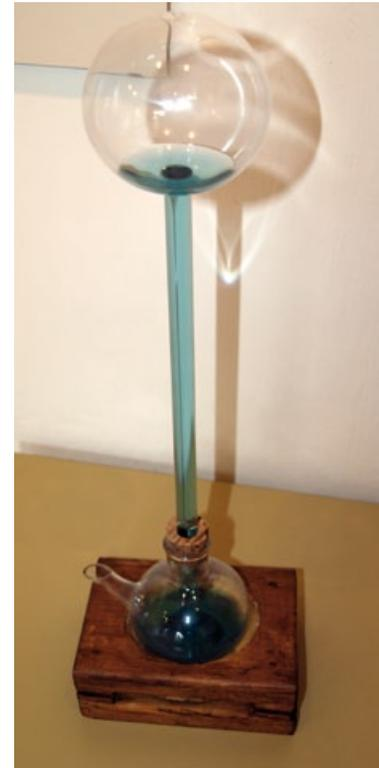
Luftthermoskop nach Galileo Galilei, Nachbau 2000 (Foto: Klaus Sturm)
