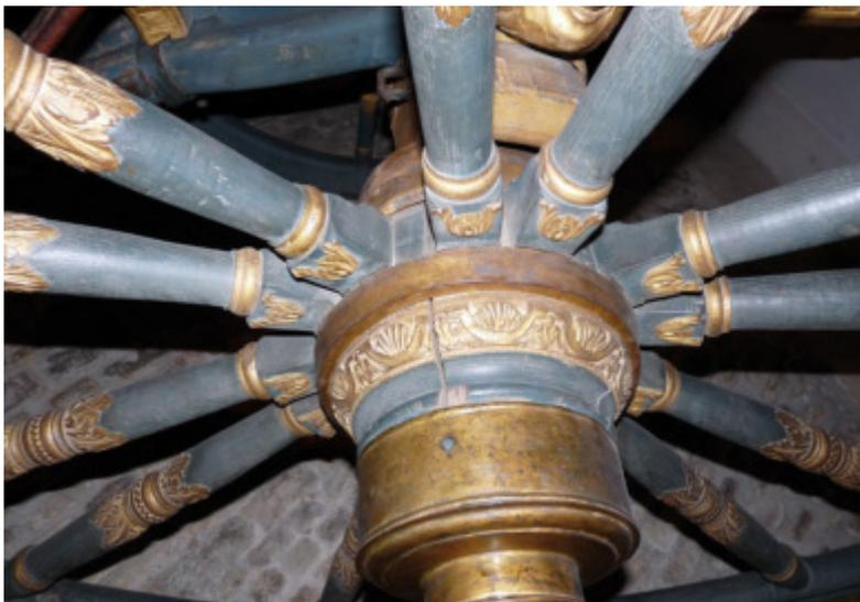
DDT-Kristalle auf der gefassten Oberfläche eines Hinterrades.
