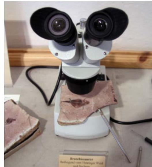
Mechanische Präparation von Branchiosauriern aus dem Rotliegend mit feinen Nadeln unter dem Binokular. (Foto: R. Werneburg)
